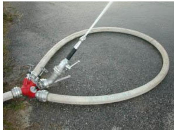
Die richtige Bedienung der Tragkraftspritze wurde von Gruppenkommandanten HLM Franz Steinbauer geschult. Um nicht ständig das B - Strahlrohr besetzen zu müssen wurde kurzerhand ein Wasserwerfer mit einem Verteiler, einem 5m B-Schlauch, einem Stützkrümmer sowie dem B-Strahlrohr gebaut.
