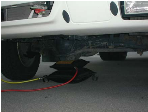
2004 – Technische Übung mit Verwendung von Hebekissen
