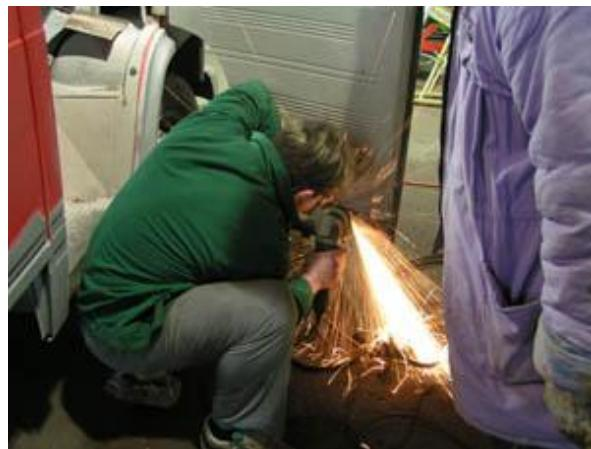
In zeitaufwendiger Kleinarbeit wurden die stark beschädigten Teile des Rahmens und der Karosserie abmontiert und erneuert.
